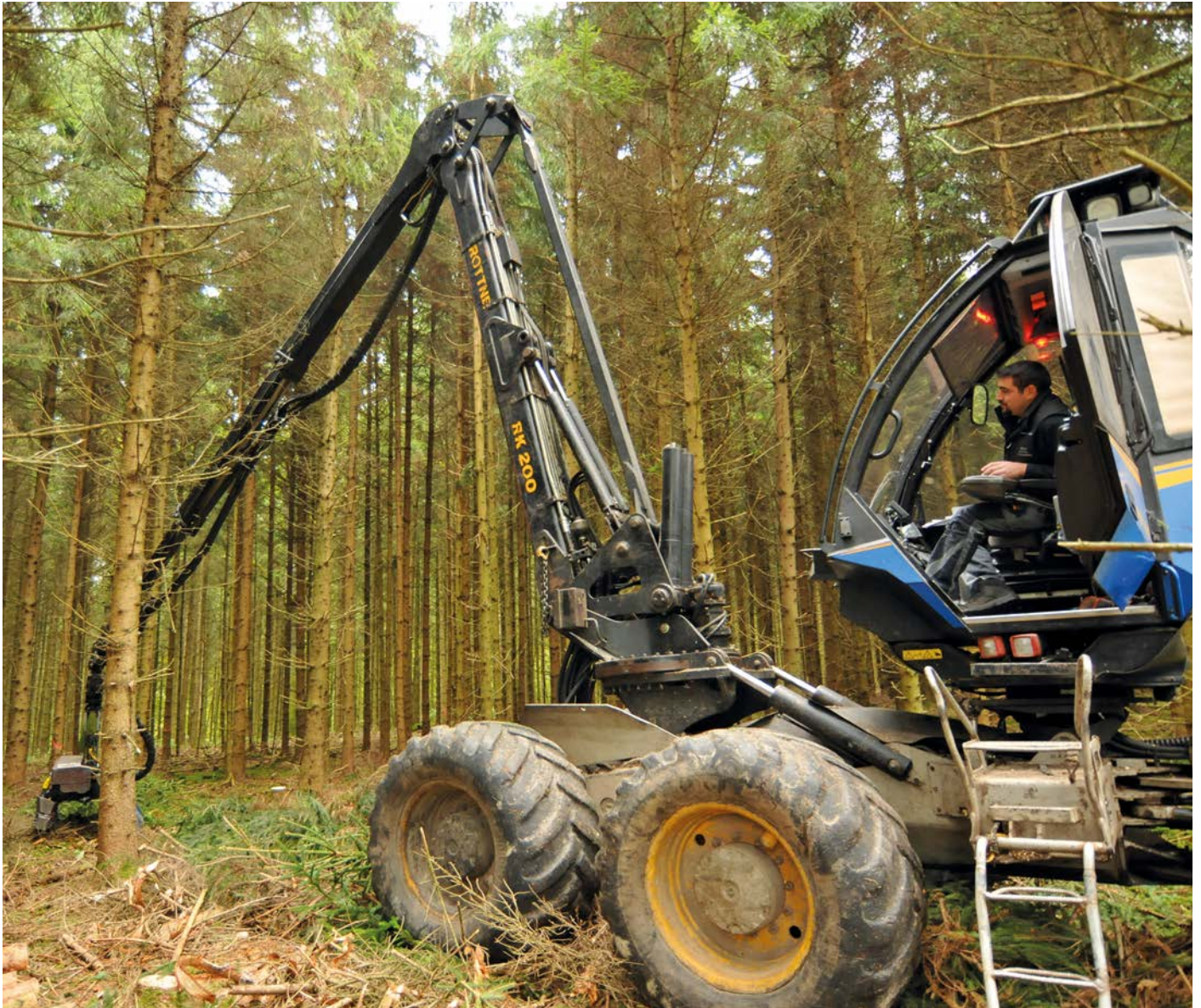
Dieses Bild sagt eigentlich schon alles. Für den 25- bis 45jährigen Nadelholzbestand wäre der Harvester Rottne H20 eigentlich etwas zu groß, aber wegen der neuen Kranreichweite von 14 Metern ist es eine ideale Trägermaschine. Man muß halt ein passendes Aggregat montieren. Hier das Keto 150 Supreme.
